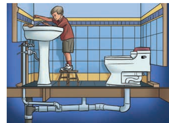
закрытый способ прокладки
