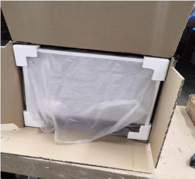
3. По углам прокладываются пенопластовые уголки
