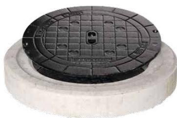
Комбинированная крышка люка DN/OD 400 бетон и чугун В125 (12,5 т) без вентиляции
