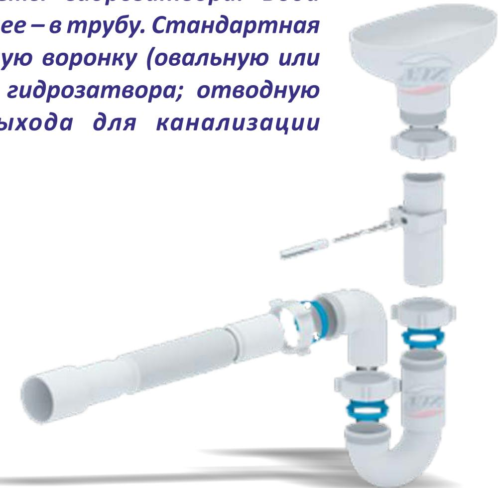
Сифоны с разрывом потока применяются там, где санитарными нормами запрещено применение обычных сифонов (из-за прямого взаимодействия отработанной воды в гидрозатворе с поверхностью раковины и её содержимым). Также, данные сифоны применяются в кондиционировании, совместно с бойлерами, где используются для сбора и отвода воды, выпускаемой клапаном из разогреветого бака и т п.
